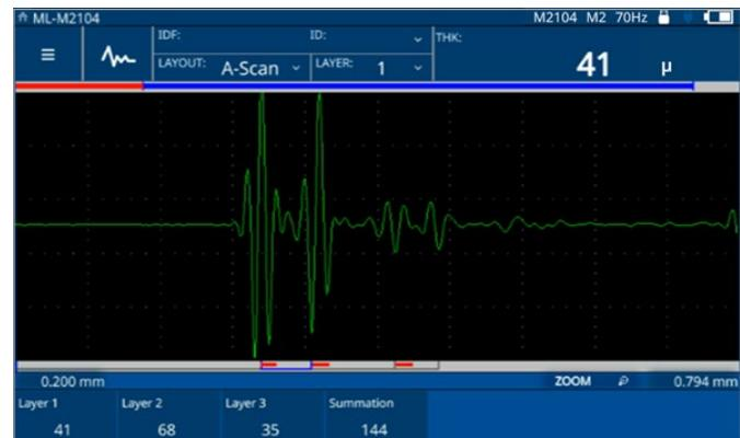
在测量复合材料上的多层涂漆时，表现出很高的测量准确性和可重复性
