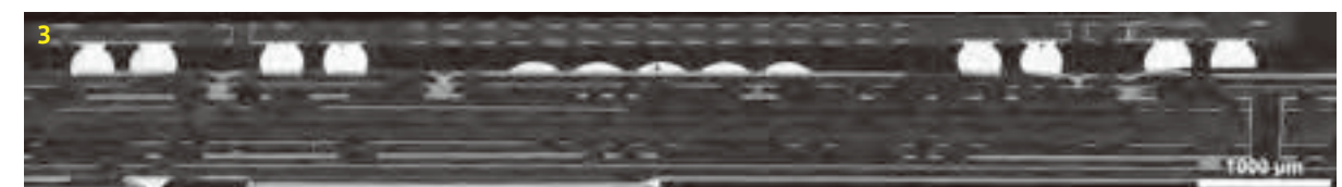
信号: 背散射电子 拍摄图像张数: 54 张 (纵 18 张 × 横 3 张) 加工装置: ArBlade® 5000
