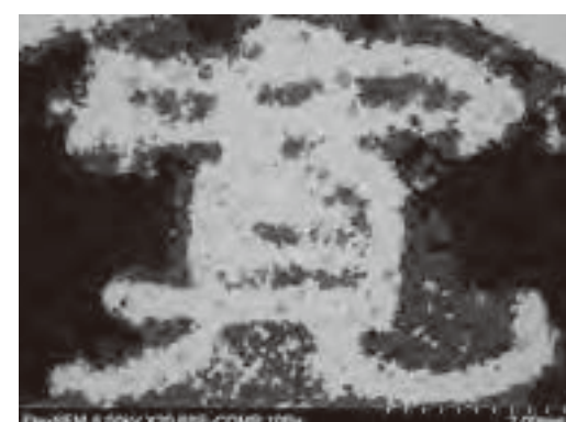
加速电压:5.0 kV 放大倍率:20 倍 样品:宽永通宝(日本货币) (采用离子研磨仪) 样品提供: 东京艺术大学 北田正弘老师
