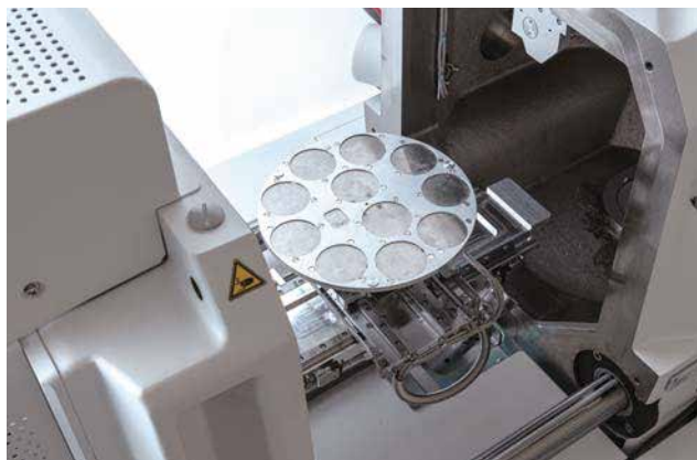
Φ47 mm×11 样品台安装示例 (SU3900SE)
