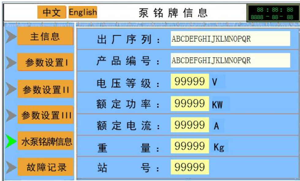
图 9 触摸屏水泵出厂信息设置画面
