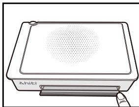
1. 打开纸匣门。注意: 先将门往下推再打开。
