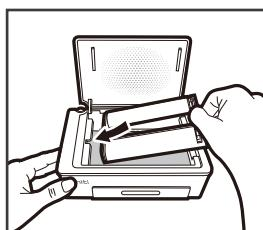
3. 按照色带匣上和印相机内部标记的箭头方向将色带匣滑入。
