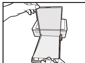
4. 打开纸匣将相纸放入纸匣内，建议一次放纸最多15张以避免卡纸。
