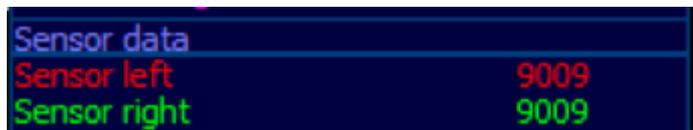
显示光标位置的实际测量角度 (9009 – 90.09°)。
