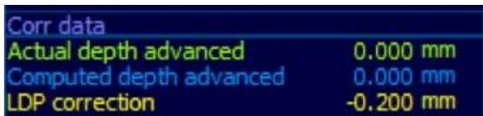
LDP 修正：将添加到原始 LDP 位置的计算修正。
