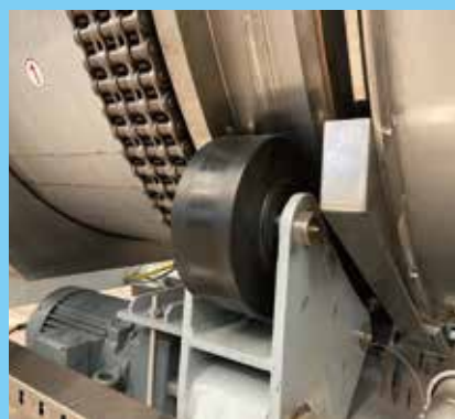
德国进口, 保险式双托轮 (隧道式洗涤机前后端各4个) 保证内筒旋转流畅, 安全运行。
