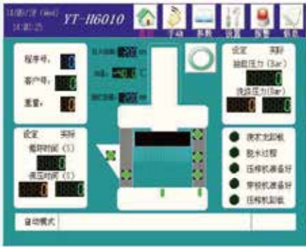
主控制界面主要用于设备运行状态的监控
