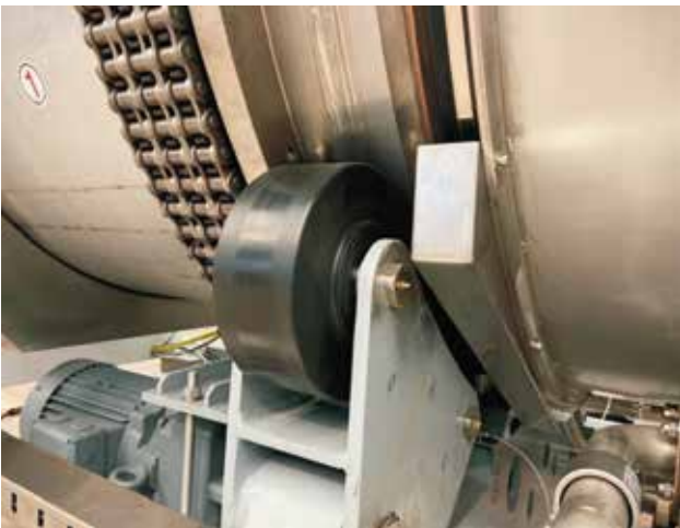
德国进口，保险式双托轮 (隧道式洗涤机前后端各4个) 保证内筒旋转流畅，安全运行。
