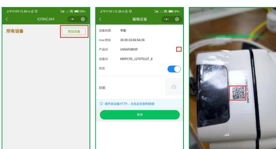
“添加设备”输入mac地址和扫描摄像头上的二维码自动获取产品ID和设备ID，再打开状态，标题和封面可根据需要填，点击保存完成设备添加。
