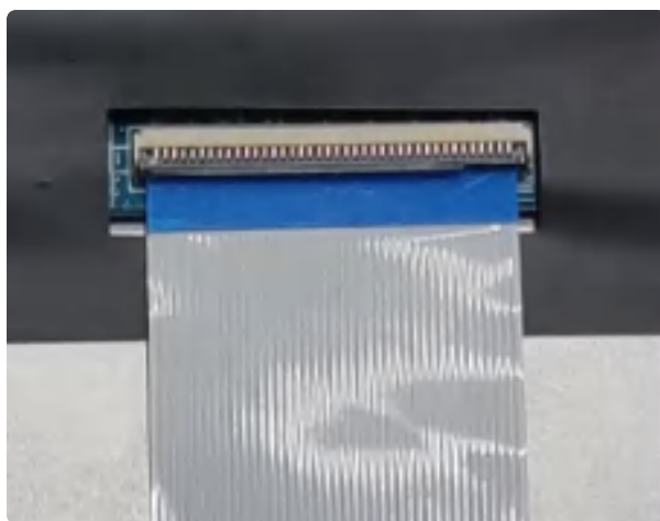
MIPI屏LCD排线接线
