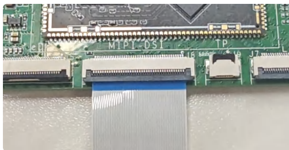
MIPI屏主板排线接线
