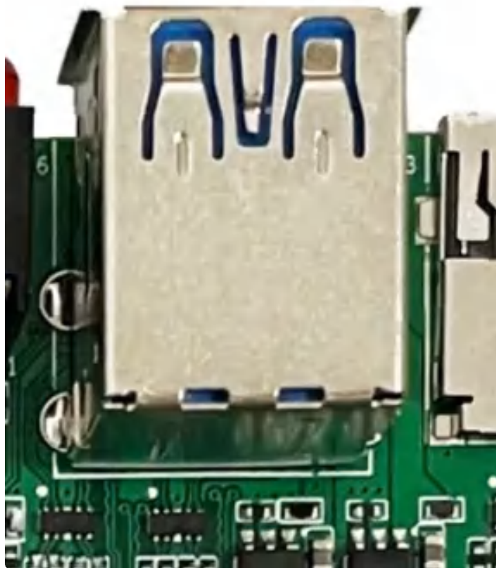
图10. IDO-EVB3568-V2 TYPE A双层座子接口示意图
