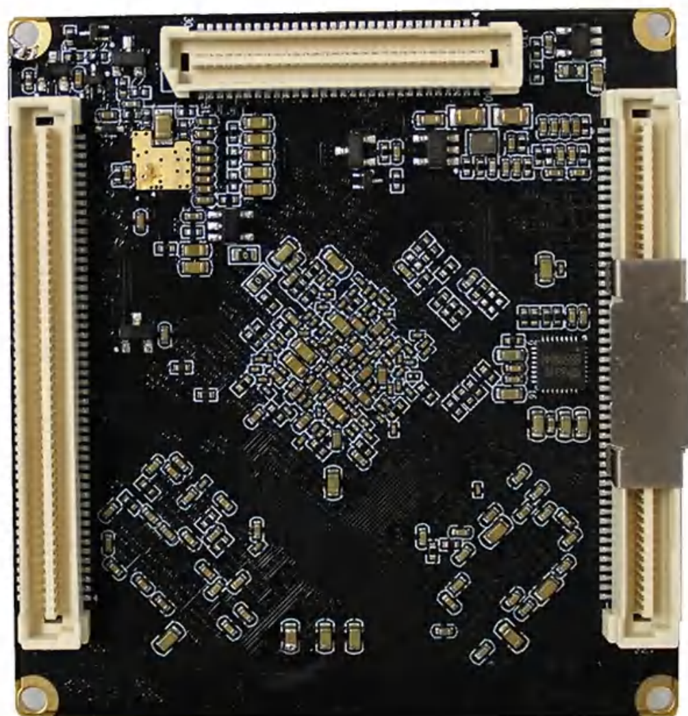
图4. IDO-SOM3908核心板背面
