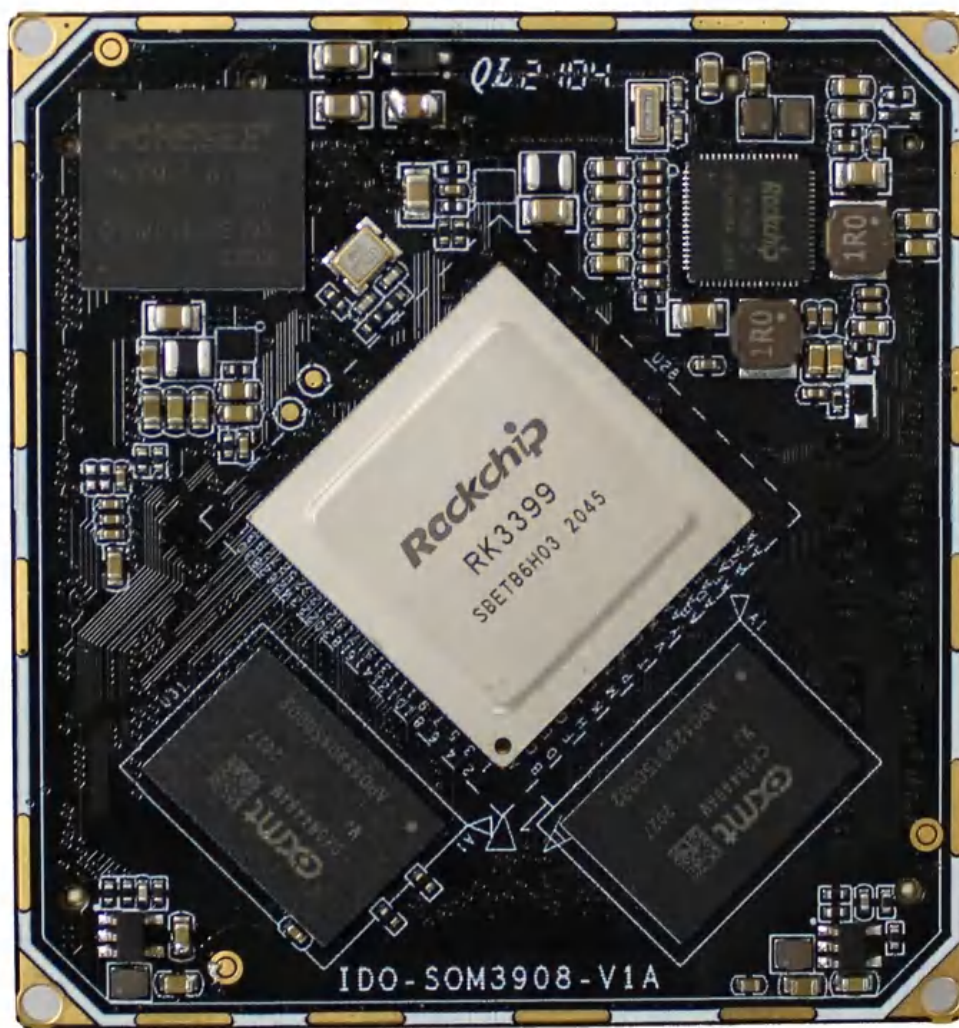
图3. IDO-SOM3908核心板正面
