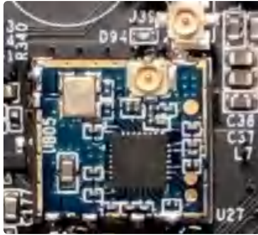
图10. IDO-SBC6Y15 IPEX天线座
