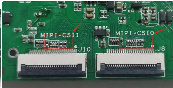
MIPI-CSI \*2接口于J9，如下图所示，支持GC2053+GC2093双目摄像头模组，连接方法如下
