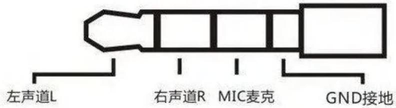
图7. IDO-EVB1126-V1耳机示意图
