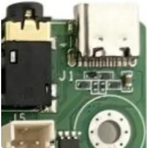
图12. IDO-EVB1309 TUPE-C USB接口
