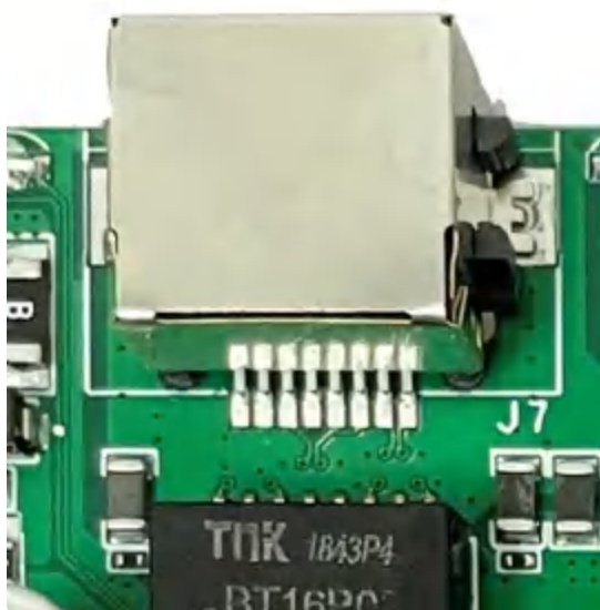
图7. IDO-EVB1309 RJ45接口
