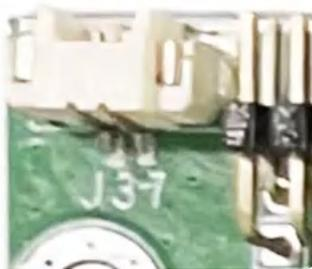
外部RTC HYM8563 电池座位于J37，规格为 MX1.25-2P 立式，可连接3V 纽扣电池，RTC电池参考如下
