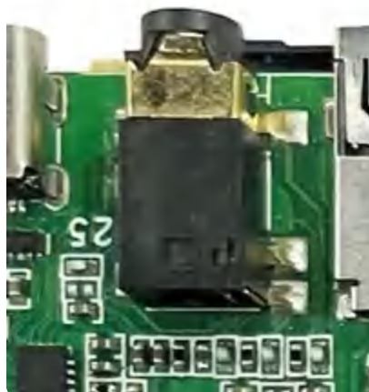
图6. IDO-SBC3968 耳机接口示意图
