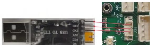
**注意：**如果使用UART适配器遇到TX和RX不能输入和输出的问题；可以尝试对调TX和RX的连接。
