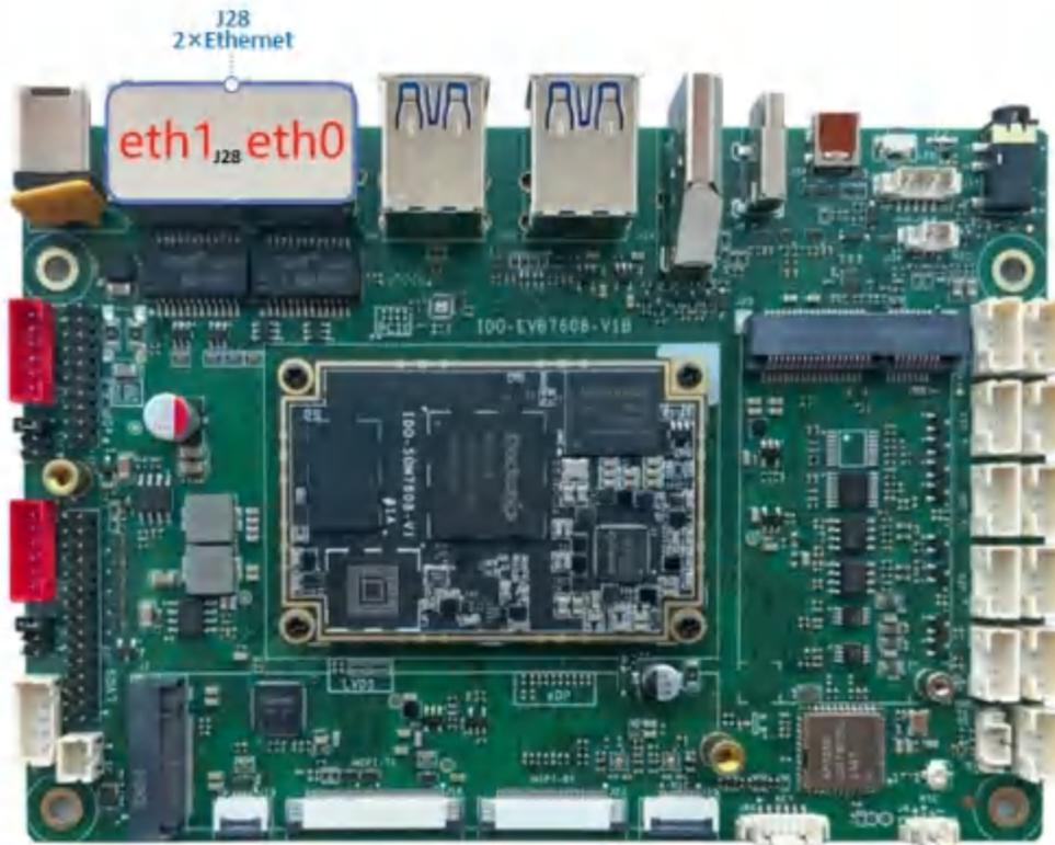
设备节点分别为eth0和eth1，以太网接口默认支持DHCP，只需要将以太网接口连接路由器即可为主板动态分配 IP 地址。网络正常连接图标，如下图所示：
