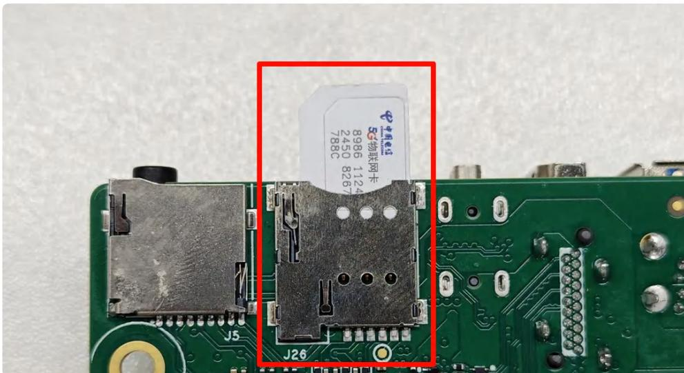
安装好4G模块和SIM卡后开机可发现4G网络，如下图所示：
