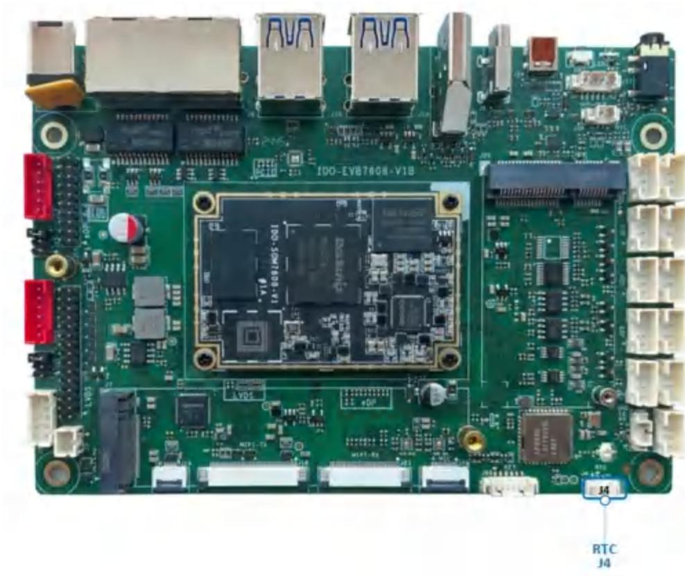
连接3V 纽扣电池， RTC电池参考如下
