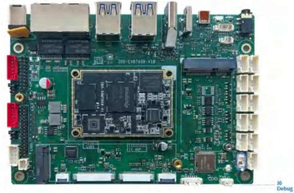
使用USB Type-C数据线，连接PC端的USB接口。系统会识别到一个“USB-SERIAL CH340”端口设备。
