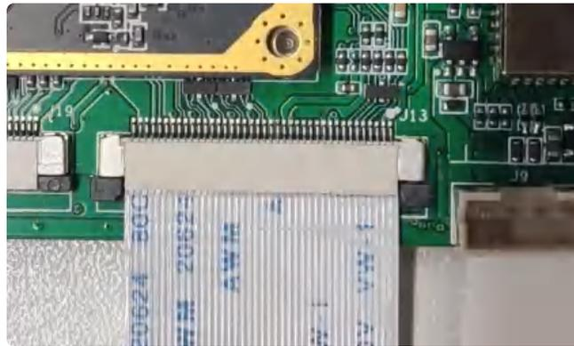
主板LCD排线接线
