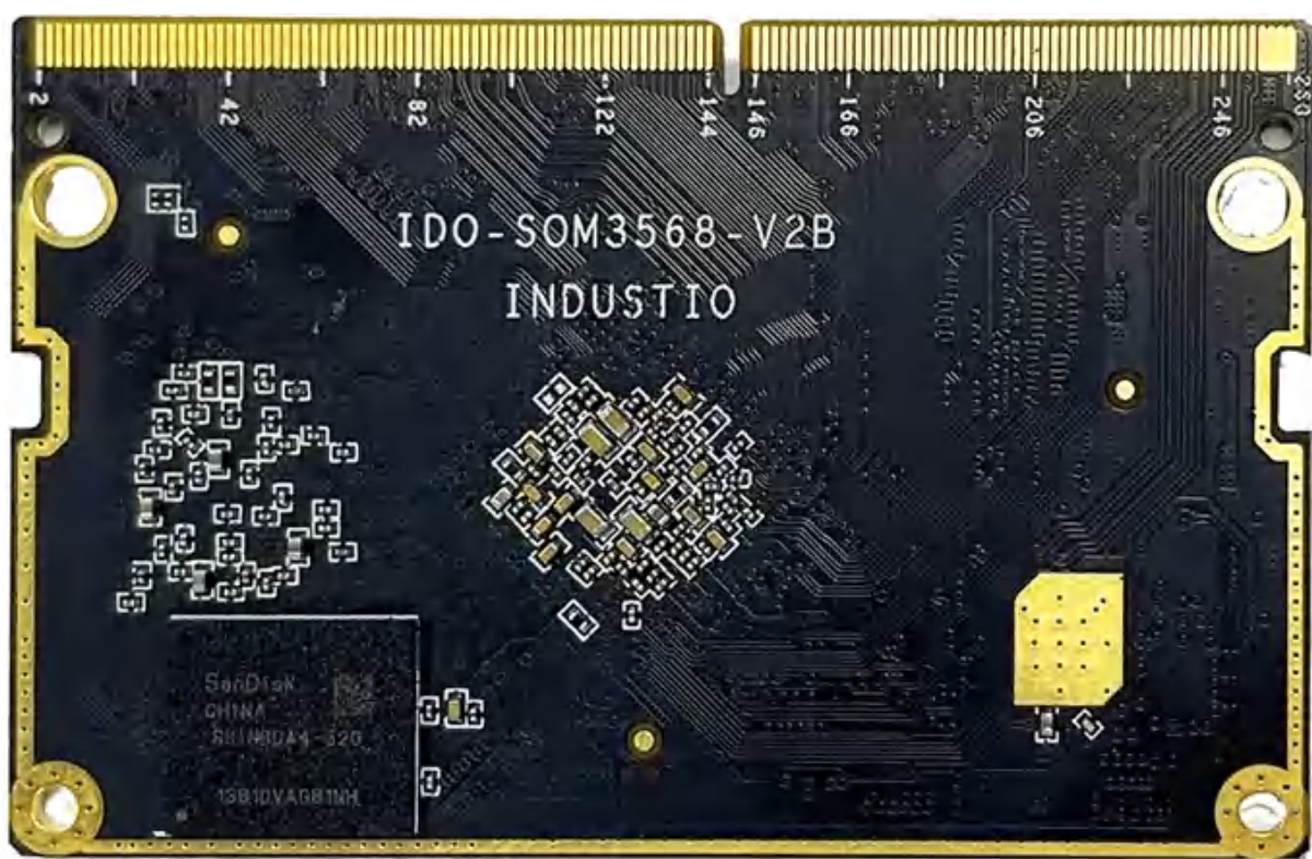
图3. IDO-SOM3568-V2核心板背面
