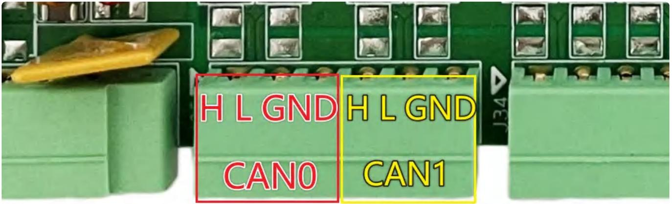
接口位置如上图所示，（此接口和DIDO硬件复用，使用前请确认硬件实际连接情况）。
