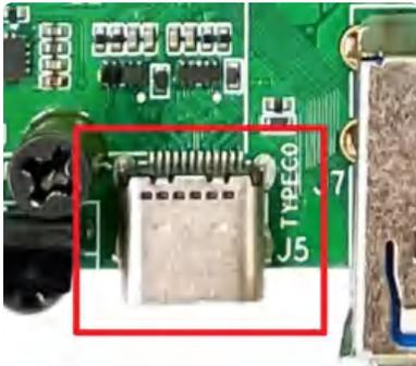
1. 将USB转type-C数据线将上图红色框中的type-C接口连接到PC端的USB接口
