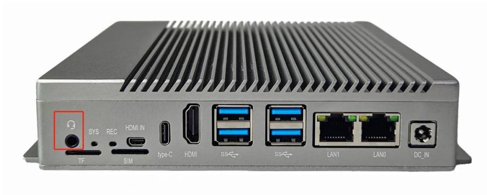
将耳机接入3.5mm耳机口，测试工具打开”喇叭“
