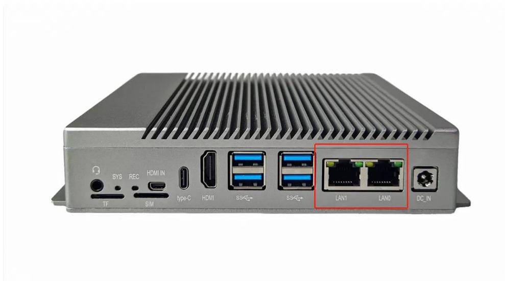
主板有两路千兆以太网接口，设备节点及位置如上图所示，以太网接口默认支持HDCP，只需要将以太网接口连接路由器即可为主板动态分配 IP 地址。如下图所示即为成功分配到ip；同一时刻只能连接一路以太网接口。
