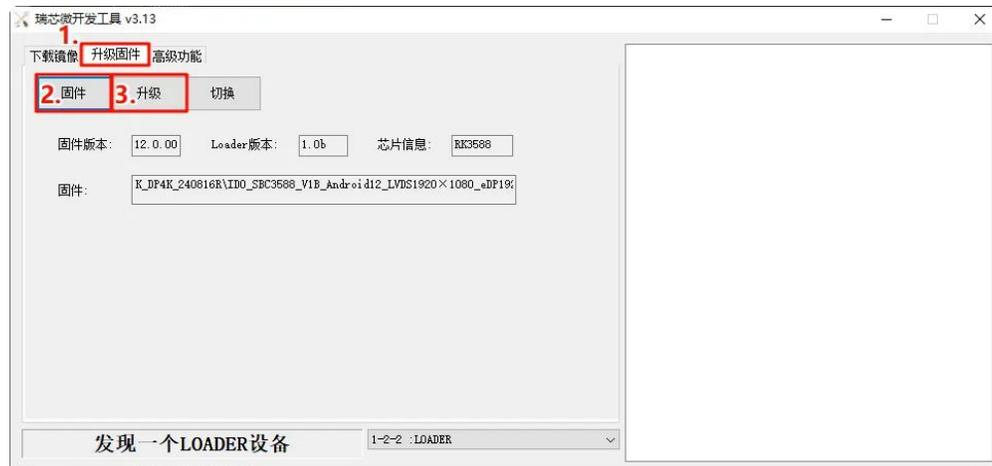
7. 加载完成后，点击【升级】按键开始下载程序，烧录完成开发板将会重新启动。
