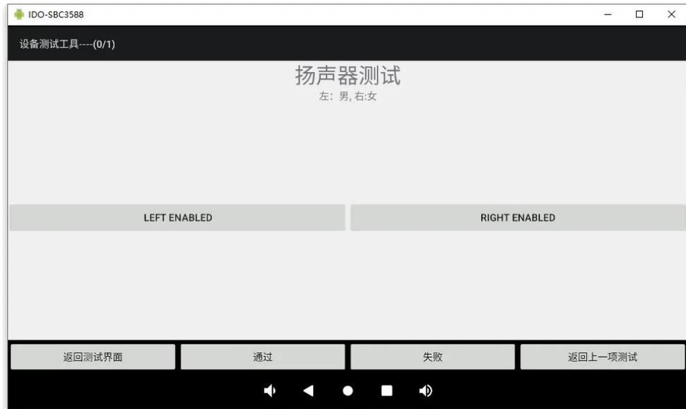
声音通过3.5mm耳机孔输出到耳机，调节声音大小音乐清晰无杂音。
