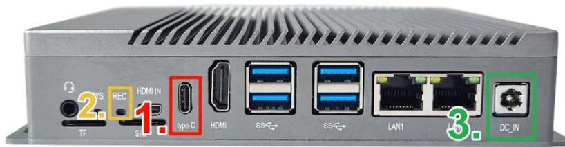
5. 烧录工具显示“发现一个LOADER设备”后，即可松开REC按键；
