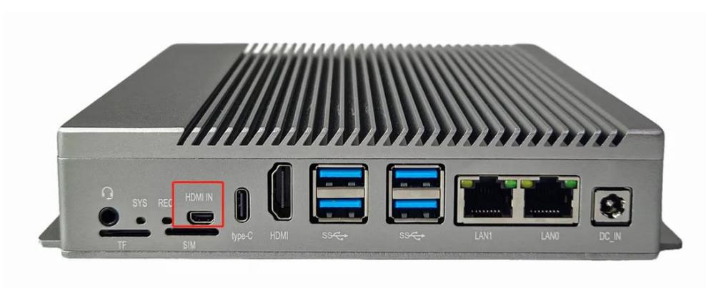
播放设备使用 Micro-HDMI 数据线连接盒子HDMI-IN接口
