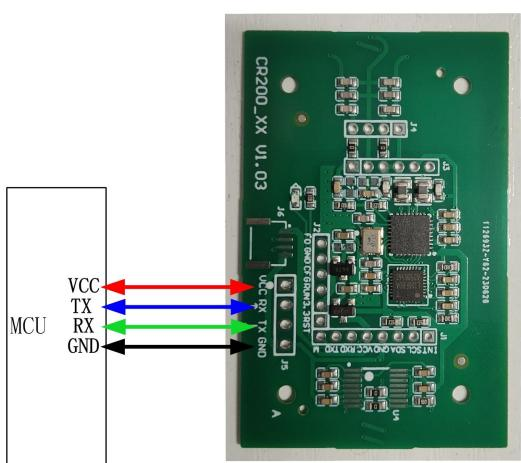
模块对外通信接口为 J5, 其中 VCC 接 5V 或 3.3V(型号带 L 字母), TX 和 RX 分别是模块的串口信号接到主控的串口即可, 默认通信波特率是 19200bps。
