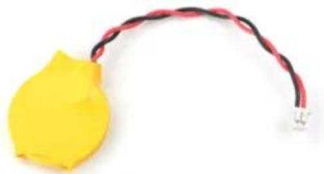
图17. IDO-EVB3588-V1 RTC电池
