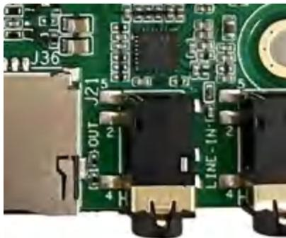
图8. IDO-EVB3588-V1耳机接口示意图
