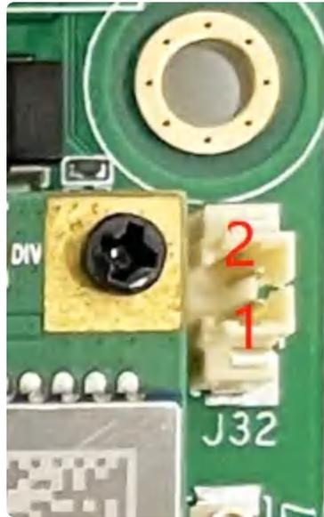
主板留有一个RTC电池接口，采用1.25mm 2P座子。保证主板在断电情况下，时间保持正常工作。
