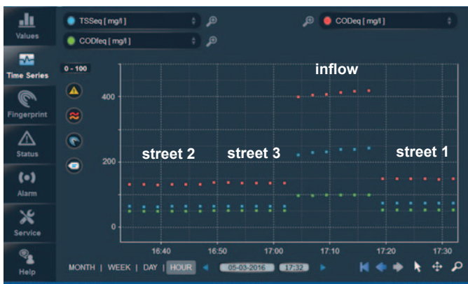
moni::tool软件可显示对污水厂入口以及街道1、街道2、街道3的出口的每十五分钟的测量结果。
