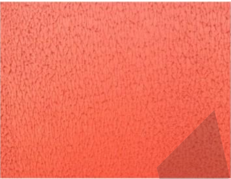
多种涂装效果，弹性好，能覆墙体盖微小裂纹，涂料不开裂
