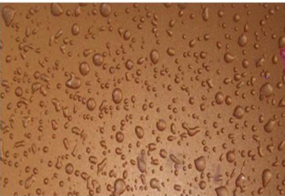
涂料具有荷叶效应，不吸水，防止潮湿发霉和脱落
