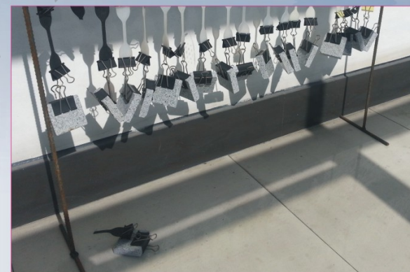
实验后: 可见一个三元乙丙样品已断裂
