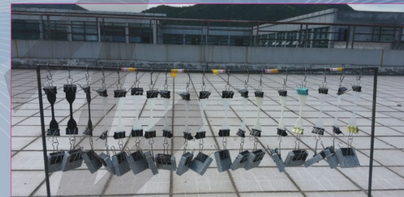
实验前: 黑色样条为三元乙丙橡胶, 白色为硅橡胶样条
