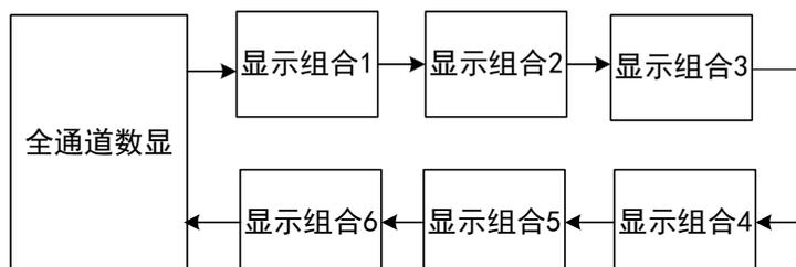
使用[确认键]启动或停止显示组合自动切换功能，每隔5秒自动切换到下个组合显示，配合有状态栏图标显示。
