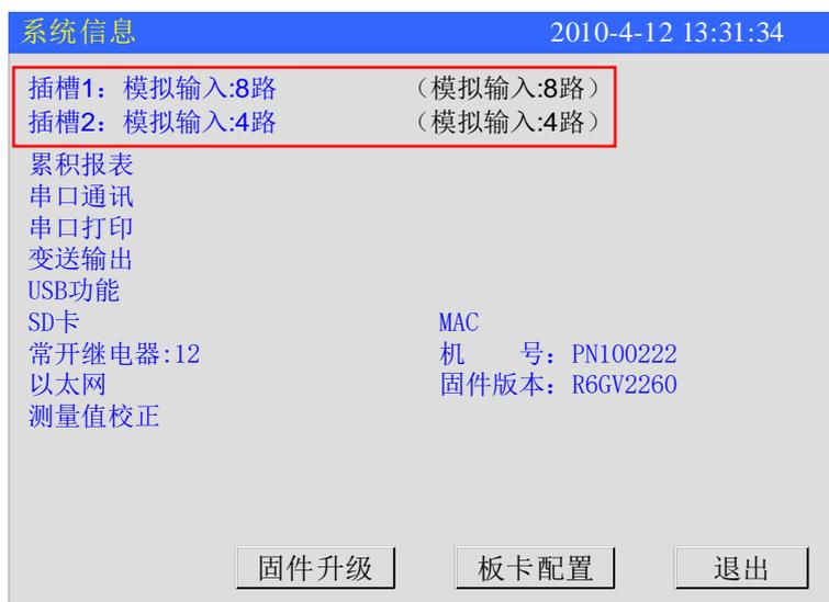
左侧文字（插槽 1：模拟输入 8 路）为仪表固有 AD 板信息，右侧文字（模拟输入：8 路）为当前 AD 板信息，如两者不一致，说明 AD 板故障，请与供货商联系维修。
