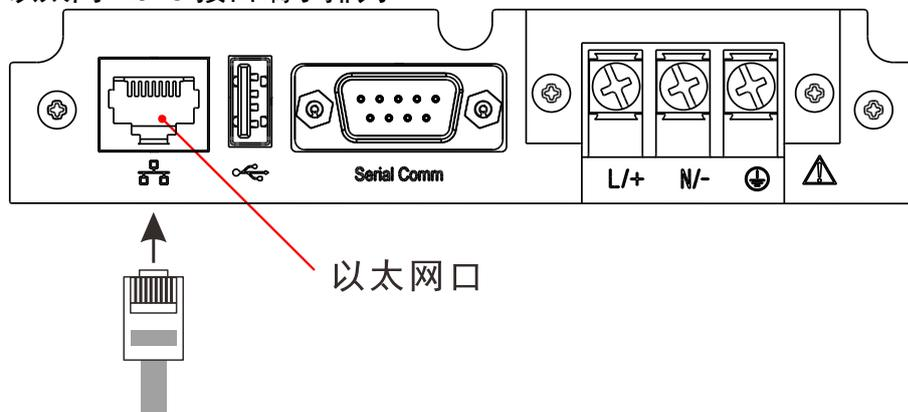
网线接头连接仪表 RJ45 接头。
