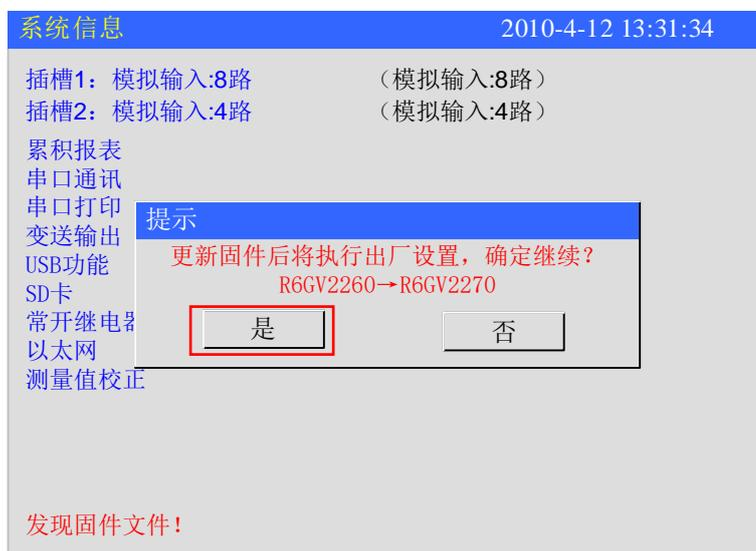
等待固件升级完成，仪表重启，回到【系统信息】界面确认固件版本已更新，拔出 U 盘。
