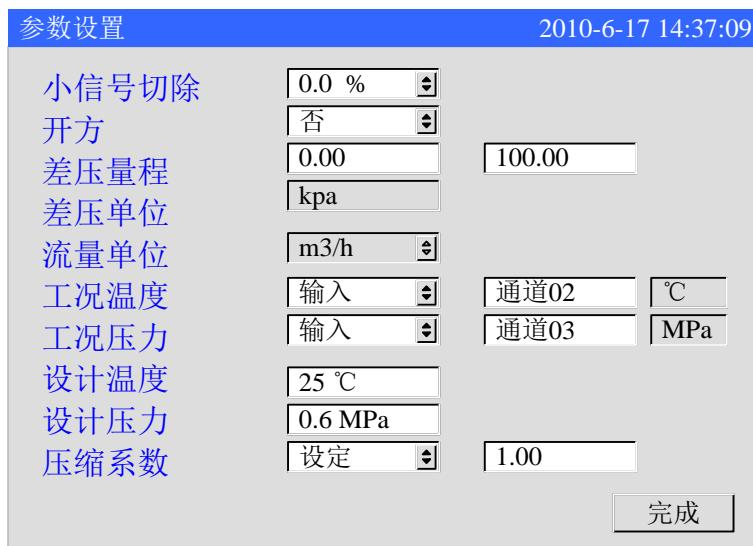
1. 小信号切除：可设定范围 0.0-9.9%，百分比表示。输入差压信号量小于设定值将规整为量程下限输入。[上下]键调整设定值。
