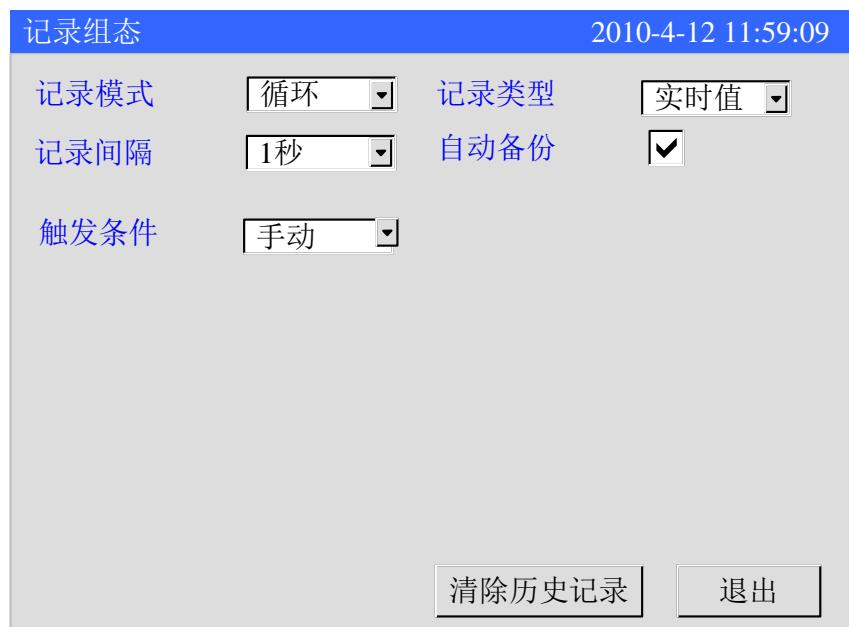
仪表触发条件有手动、报警、继电器、开关、定时、上电。
