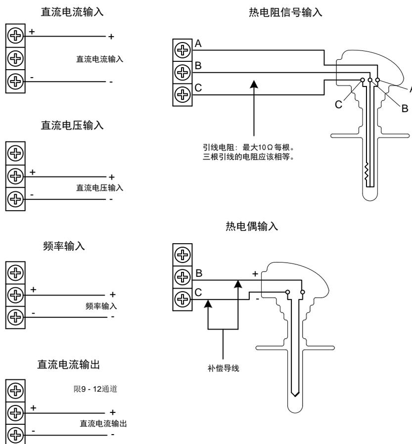
注：输入通道选数字信号，信号类型选有源开关的按[直流电压输入]接线，选无源开关的按[热电阻信号输入]接线。
