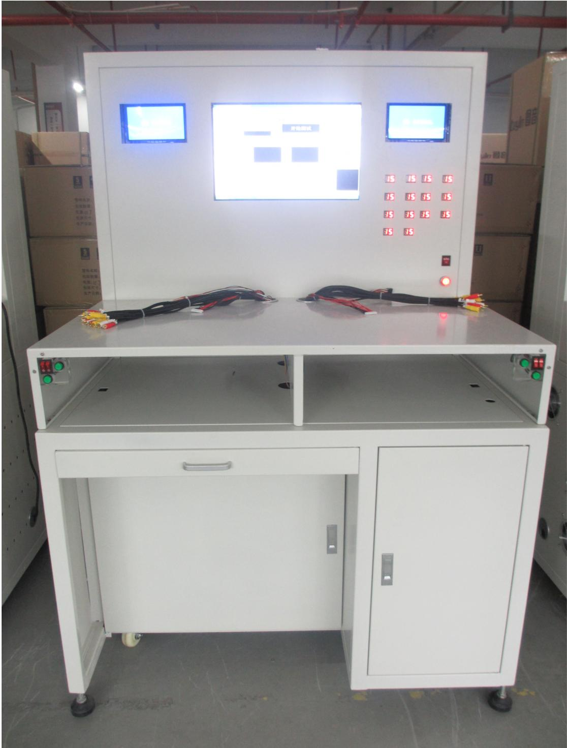
下图是正在运行的**车载影音产品自动测试系统**，边测试边连接测试线，实现交替测试，节约接线的时间。
