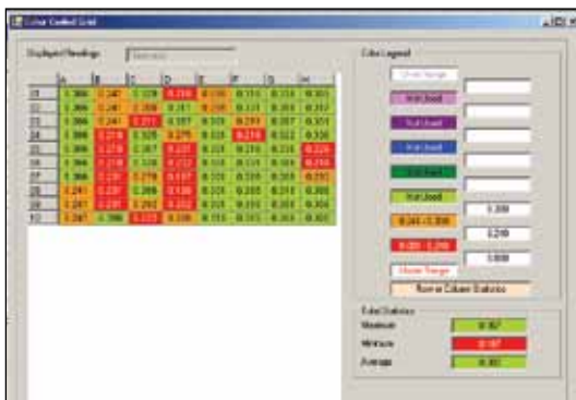
在PC机上可以看到以栅格形式出现的数据通过不同颜色清晰地标明超出容差的厚度情况。
