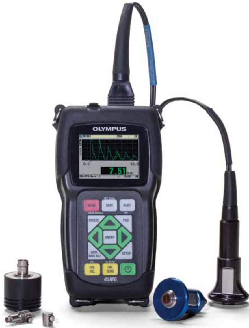
图中仪器屏幕上显示有可选波形
