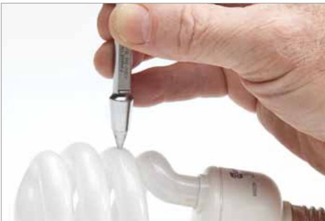
使用V260-SM Sonopen探头对薄玻璃进行测量。
